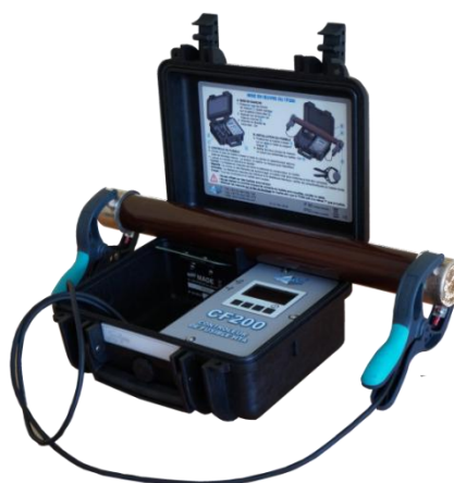
Positionnement du fusible sur la valise
