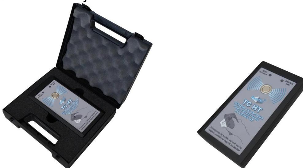
Le TC HT génère un champ électrique simulant la présence d'une ligne électrique. Il suffit de centrer le boîtier TC HT sur le capteur et d'appuyer sur le bouton en face avant.
