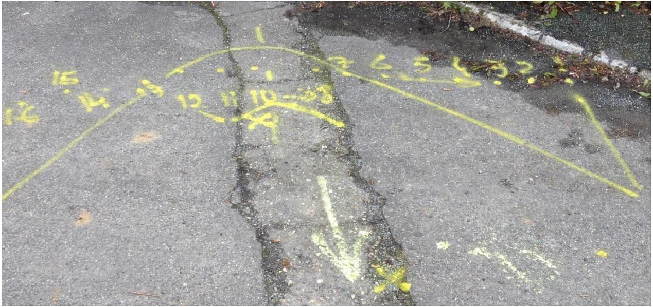
Le signal décroît brusquement au passage dans la tranchée, du fait d'un compactage différent. L'interprétation est schématisée ci-contre par 2 courbes en cloche imbriquées. Le point 10 (extremum relatif dans la tranchée) désigne l'aplomb de la canalisation.
