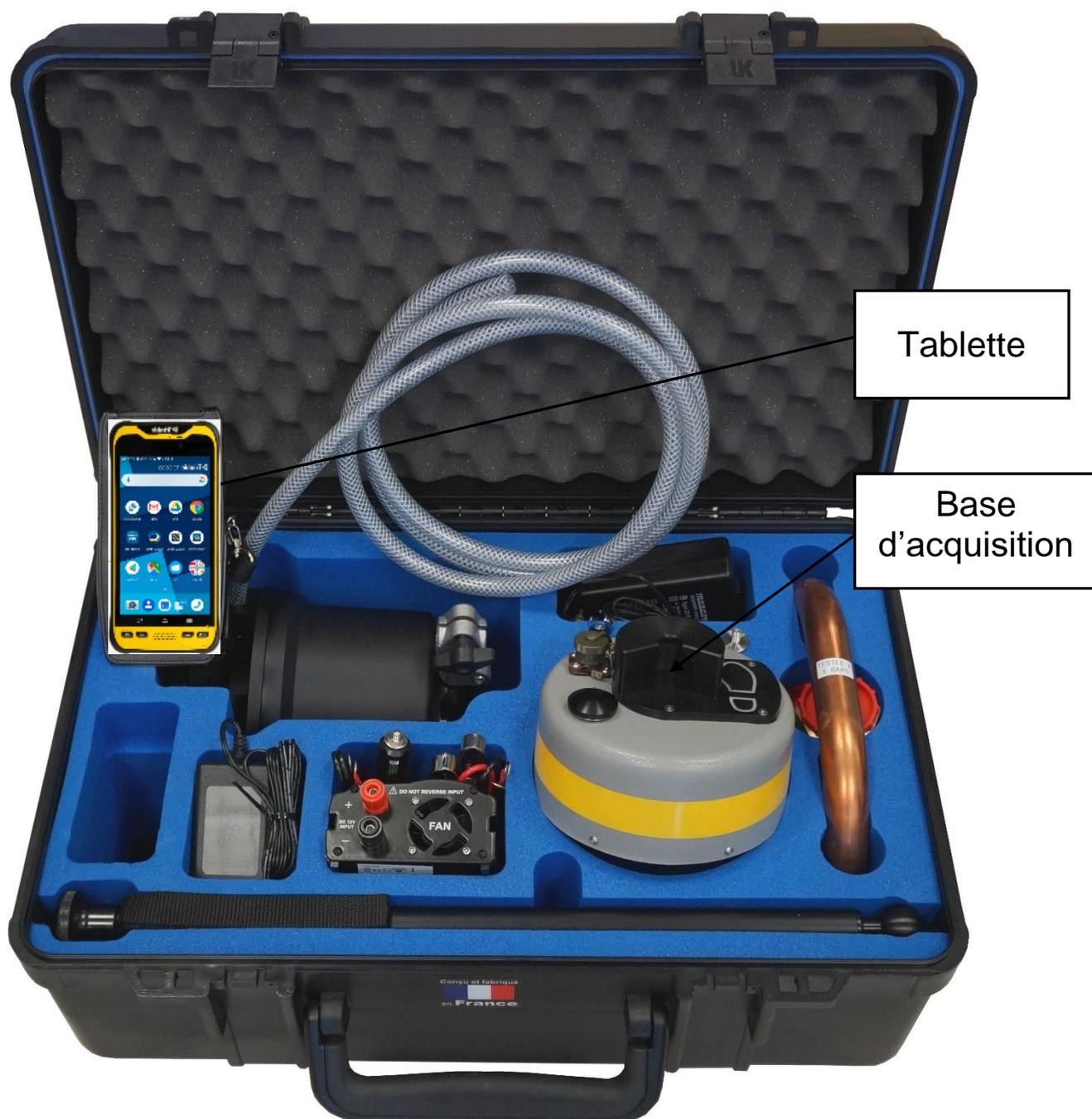
Une liaison sans fil assure la communication entre la base d'acquisition et le récepteur (Tablette). Le récepteur possède un écran tactile, toutes les commandes utilisateurs sont passées en appuyant sur l'écran (avec le doigt) sur les idéogrammes et commandes correspondantes.
