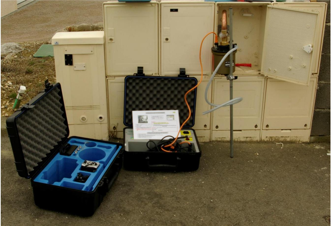
Le caisson d'émission s'appuie sur le coffret client. Un pied de soutien est intégré à la poignée du caisson. Le pied est réglable par une mollette afin d'ajuster la hauteur du caisson.
