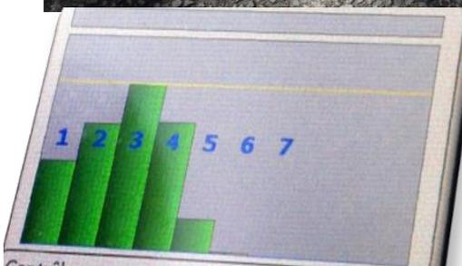
Courbe en cloche classique, la canalisation est localisée sous le point n°3.
