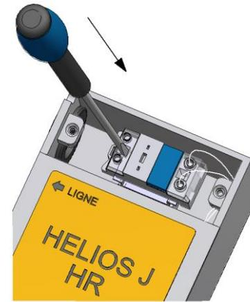
1- Positionner un tournevis (plat 4mm) jusqu'en butée dans le poussoir transparent.
