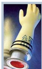
Avant toute utilisation des gants diélectriques pour des travaux sous tension, les normes EN 60903 et CEI 60903 recommandent une inspection visuelle par un gonflage à l'air des gants afin de détecter d'éventuelles fuites.
