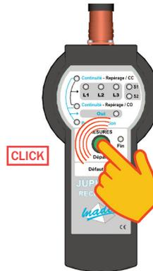
Appuyer sur mesure. Attendre le résultat (3 secondes), la LED FIN MESURE s'allume.
