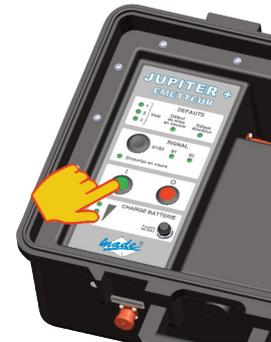
Raccorder l'émetteur et appuyer sur le bouton
