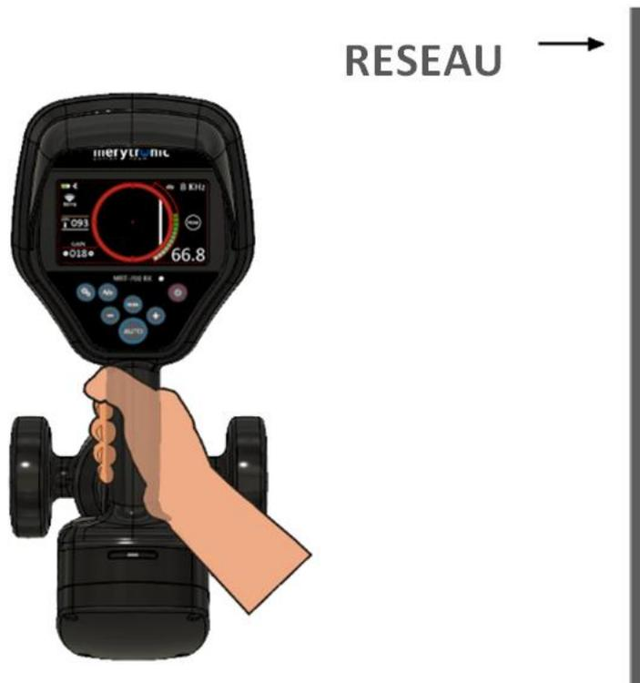
6) Le signal augmente (83.0) et le réseau se rapproche du centre du récepteur.
