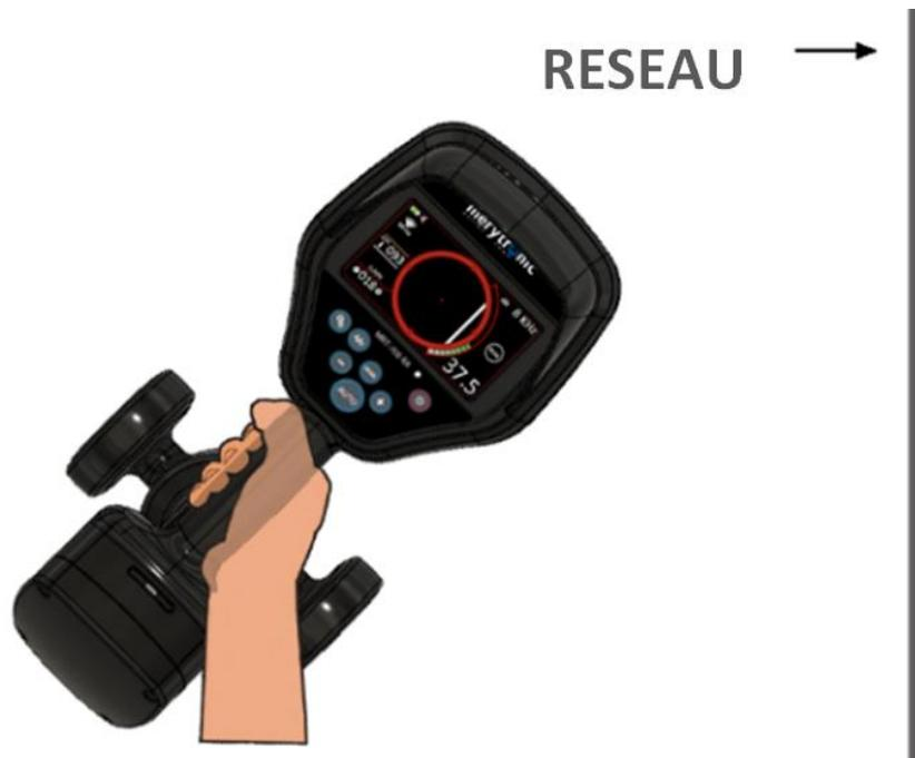
Une fois le MRT-700 parallèle au réseau, il faut se déplacer afin d'être parallèle à la cible.
