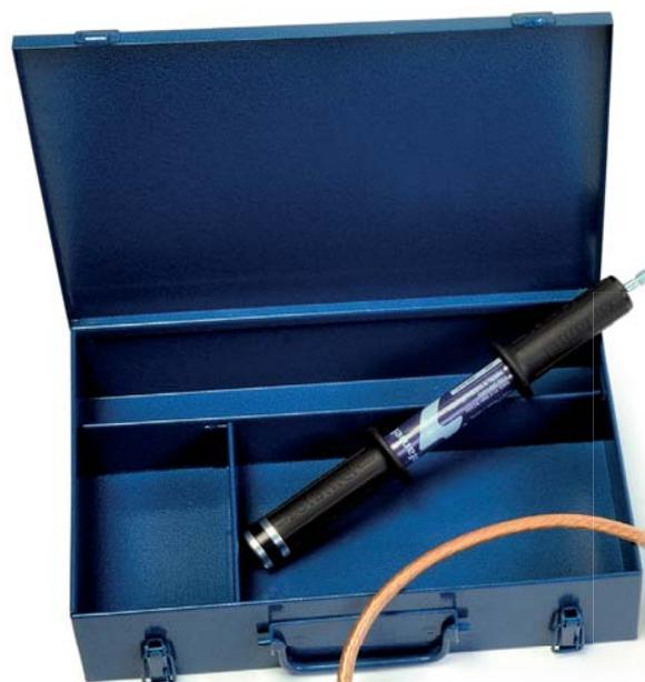
Équipement de mise à la terre et en court-circuit pour tableaux électriques basse tension. L'objectif principal de son installation est la protection du travailleur contre une mise en marche accidentelle ou un éventuel retour de tension lors de travaux de réparation. Dispose d'une perche isolée adéquate pour l'extraction des lames grâce à un filet M-10. Conforme à la norme CEI 61230.
