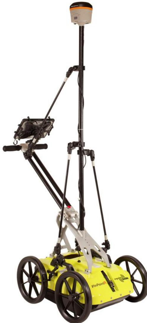
*Figure 7* Supports de GPS sur le chariot
