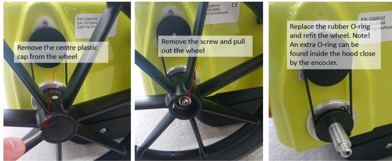
*Figure 6* Codeur d'odomètre et assemblage de la roue
