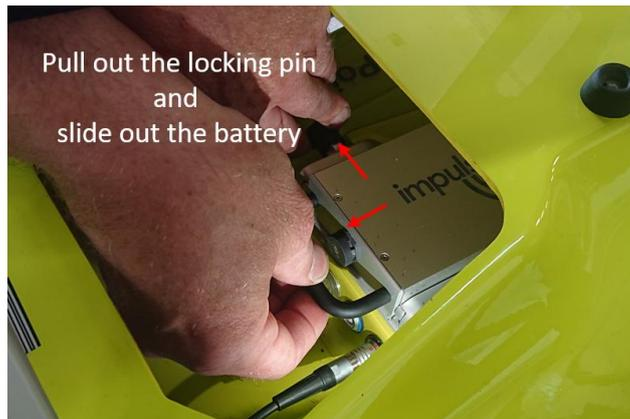
Figure 3 Montage de la batterie
