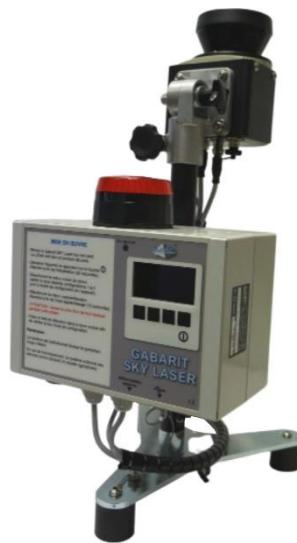
Orientation du LIDAR pour une surveillance horizontale
