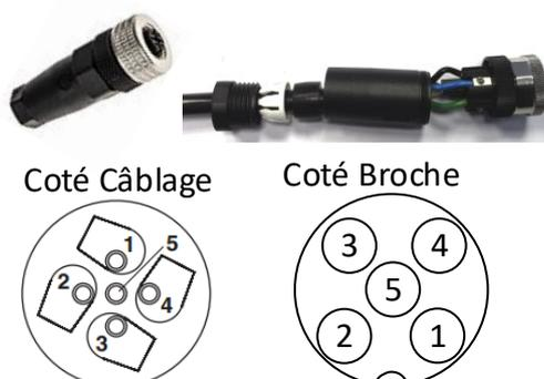
Raccordement alimentation – activation de l’alarme:
