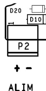
Ouvrir le boîtier et connecter le câble (+ - 12/24V) sur P2
