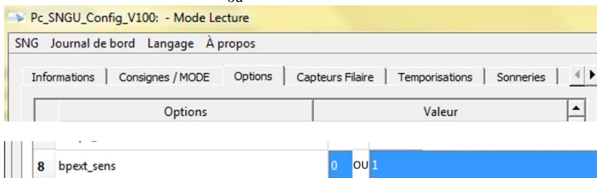
Une autre manière est d'inverser le sens de bpxt\_sens à l'aide du logiciel « SNGU\_Config\_Vxxx »).
