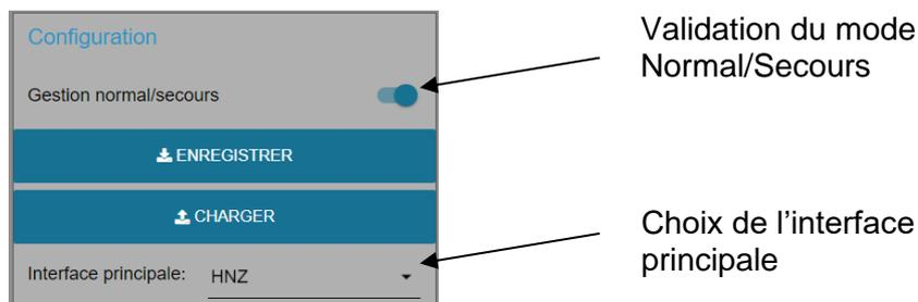
En cas d'échec de diffusion d'une alarme sur l'interface principale, elle sera diffusée sur l'interface secours.
