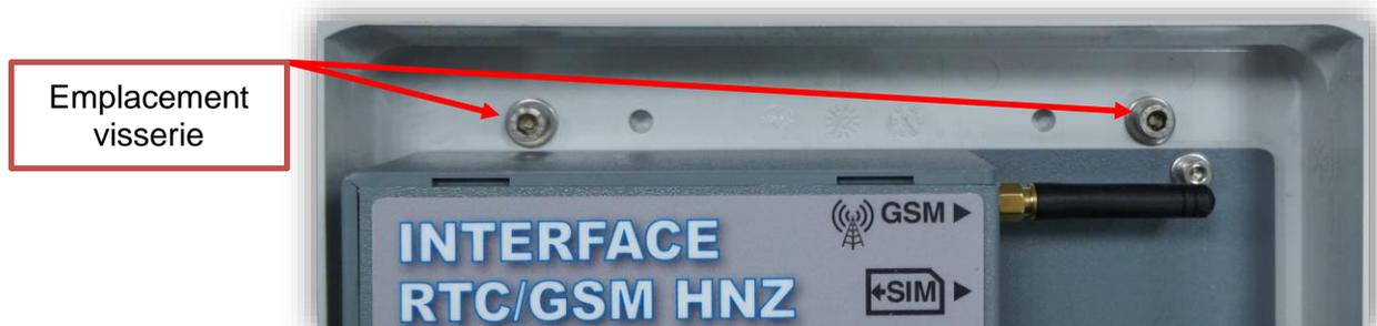
Figure 3 - Emplacements réservés au montage des griffes
