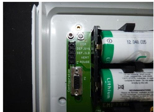
Le bornier débrochable accepte des câbles de section allant de 0.08 à 2.5 mm<sup>2</sup>.
