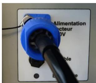
③ Verrouiller la fiche secteur en effectuant une rotation dans le sens des aiguilles d'une montre jusqu'à l'enclenchement du bouton de verrouillage en position haute :
