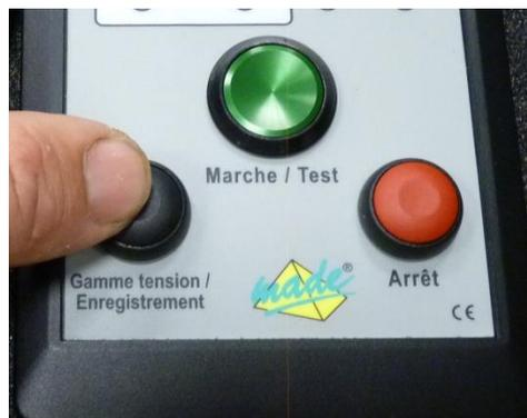
Les données enregistrées pourront être transférées ultérieurement vers le logiciel d'exploitation (cf §4). Il est possible de sauvegarder 10 campagnes de mesures. Le stockage est géré automatiquement par le testeur de manière à ce qu'un nouvel enregistrement écrase le plus ancien lorsqu'il y a plus de 10 enregistrements.
