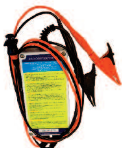
Connecteur de câble sous tension permettant d'injecter le signal du générateur sur des câbles sous tension
