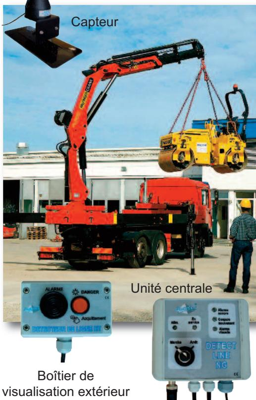
DETECT LINE NG est un détecteur de lignes Haute Tension : HTA (< 50 kV) et HTB (> 50 kV).
