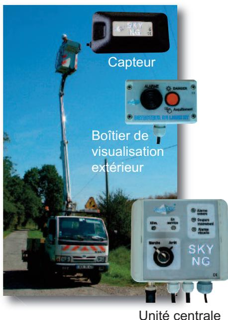
SKY NG NACELLE est un détecteur de lignes Haute Tension : HTA (< 50 kV) et HTB (> 50 kV). SKY NG NACELLE prévient l'utilisateur par une alarme sonore et visuelle lorsque l'engin élévateur pénètre dans une zone à risques à une distance configurable entre 3 et 6 m d'une ligne HTA.
