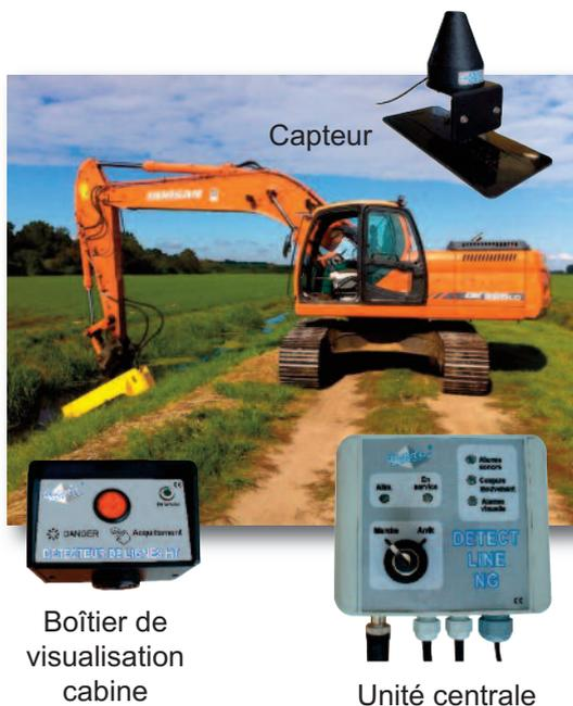
DETECT LINE NG est un détecteur de lignes Haute Tension : HTA (< 50 kV) et HTB (> 50 kV). DETECT LINE NG prévient l'utilisateur par une alarme sonore et visuelle lorsque l'engin élévateur pénètre dans une zone à risques à une distance configurable entre 10 et 40 m d'une ligne HTA.
