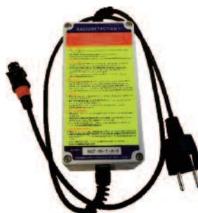
Connecteur de prise domestique permettant d'injecter le signal d'un générateur sur un câble basse tension
